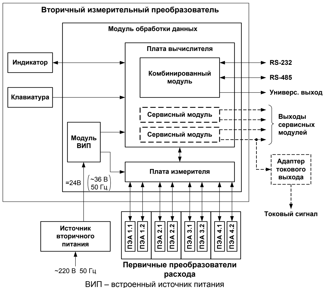
Рис. 4. Структурная схема четырехканального расходомера.
